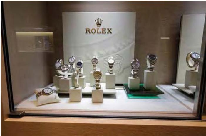
Vor der Umrüstung durch MüllerKälber: Dieses Fenster ist nicht optimal beleuchtet. Der Ladenbauer hatte bei der Konstruktion des Fensters nicht das Licht bedacht: Die Lichtquelle ist zu weit hinten, was dazu führt, dass viele Uhren „im Schatten“ stehen.
